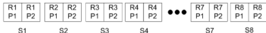
図 3: 唯一-丁合いを使用した単一レコード面付けの例 (8 レコード、1 レコードあたり 4 ページ、1 行 x2 列のレイアウト、片面印刷、R=レコード、P=ページ、S=シート)
