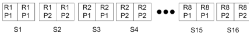
Figura 2: Esempio di imposizione di record singoli con stampa multipla con elementi unici per 8 record, 2 pagine per record, layout 1 riga x 2 colonne, lato singolo. R = Record, P = Pagina, F = Foglio
