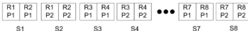
Abbildung 5: Die folgende Abbildung veranschaulicht die Ausgabe für die Sammelform „Mehrsatzmodus – Sortieren“ bei folgenden Festlegungen: Sammelform = Mehrsatzmodus – Sortieren // 8 Datensätze und 2 Seiten pro Datensatz // Layout mit 1 Zeile und 2 Spalten // Simplexdruck (R = Datensatz, P = Seite, S = Bogen)
