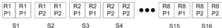
Рисунок 2: Пример спуска полос для одной записи с использованием варианта «Несколько на листе — уникальные» для 8 записей, 2 страницы на запись, с компоновкой «1 строка x 2 столбца», односторонняя печать. R = запись, P = страница, S = лист.
