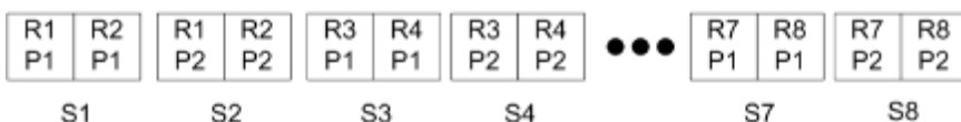
그림 4: 8개 레코드, 레코드당 2페이지, 1행 x 2열 레이아웃, 단면의 복수 레코드 모으기의 예. R = 레코드, P = 페이지, S = 시트
