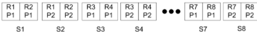
图 4: 例如 8 个文档（每个文档包含 2 页，版面为 1 行 x 2 列，单面）的多文档排序。R = 文档，P = 页面，S = 印张
