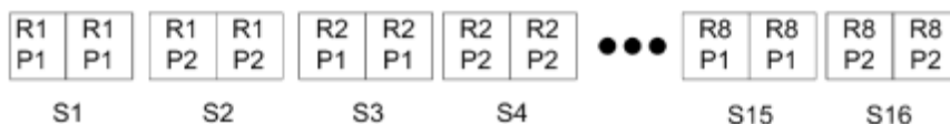
Figura 1: Esempio di imposizione di record singoli con stampa multipla con elementi ripetuti per 8 record, 2 pagine per record, layout 1 riga x 2 colonne, lato singolo. R = Record, P = Pagina, F = Foglio
